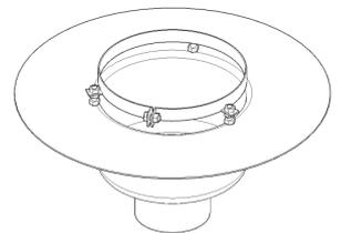
5 ... Aufsatzstück einsetzen, leicht klemmen für einfache Verstellung per Hand.
