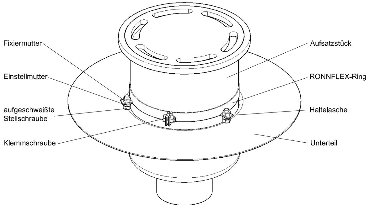
1 ... Unterteil des Ablaufes bereits in den Bodenaufbau eingebaut.
