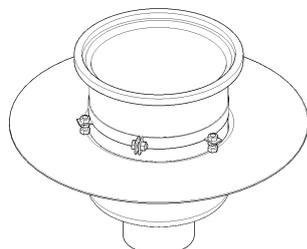
7 ... mit den Einstellmuttern die exakte Endlage einstellen, anschließend die Fixiermuttern festziehen.
