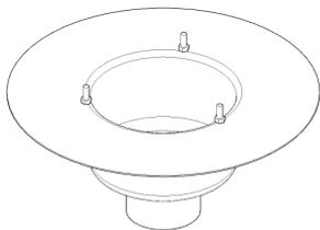
2 ... Einstellmuttern ca. zur Hälfte auf die Stellschrauben des Unterteil aufschrauben.
