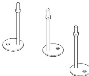
3 ... Verstellfüße von unten auf die Haltetasche setzen, Fixiermutter aufdrehen und leicht klemmen
