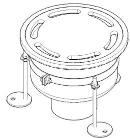
4 ... Bodenablauf auf Kanalmuffe setzen, RONNFLEX-Ring entsprechen Montagehöhe verschieben und Verstellfüße im Boden fixieren
