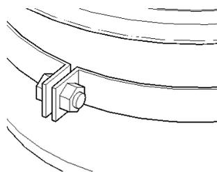
6 ... mit den Einstellmuttern die exakte Endlage einstellen, anschließend die Fixiermutter festziehen.
